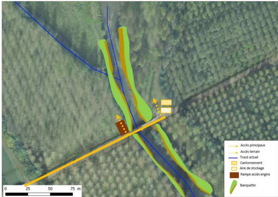
Figure 19 : Accès et installations de chantier sur le site de Conflans-sur-Loing
